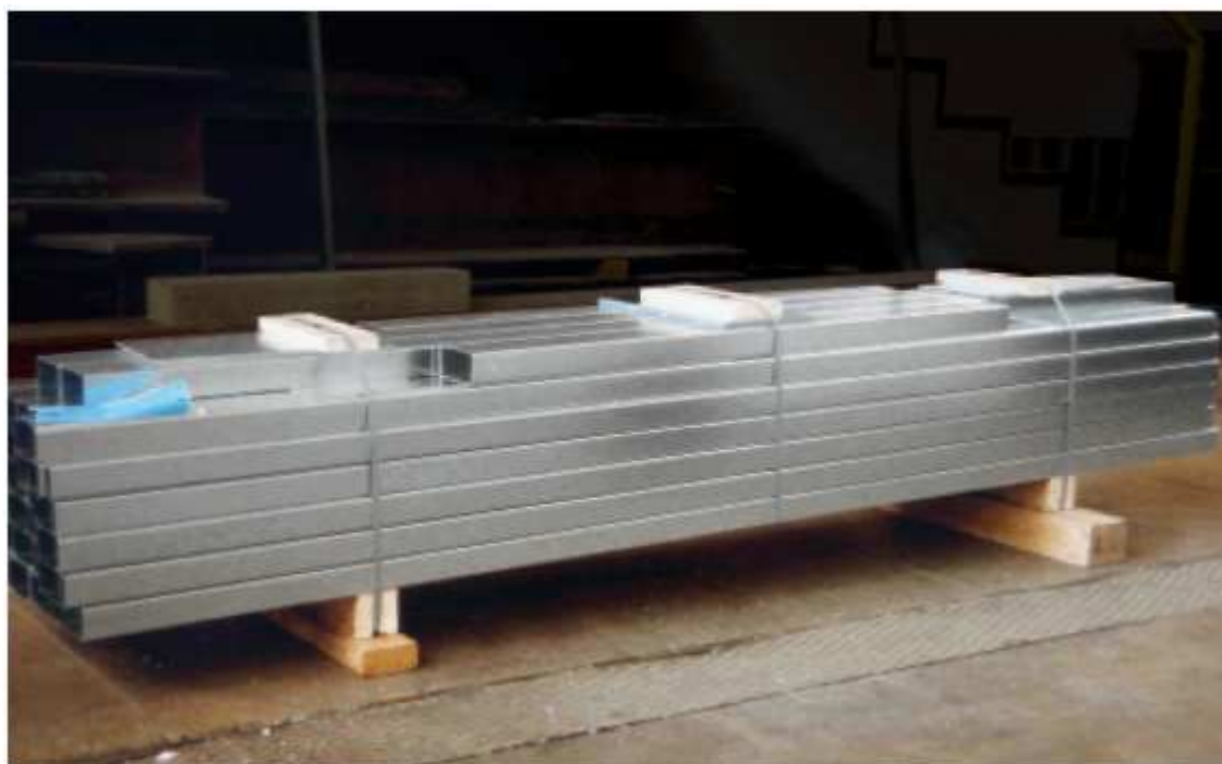
Рис. 115: С целью защиты от коррозии профили укладываются на хранение с легким наклоном
