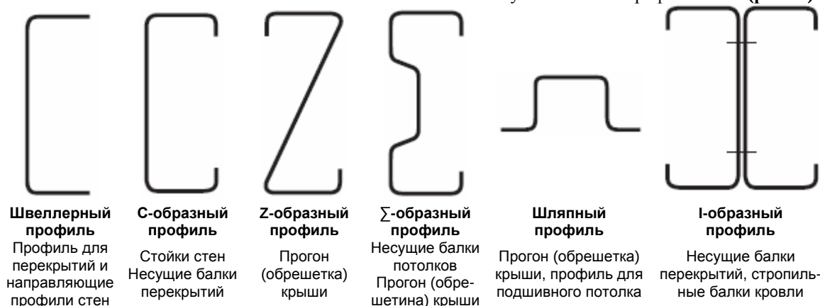
Рис. 33: Формы поперечного сечения холодногнутых профилей, используемых в жилищном строительстве
