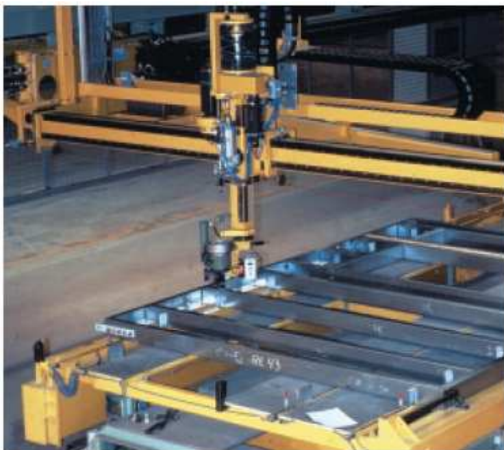
Рис. 46: Изготовление стенных панелей с при- менением ро- бототехники
