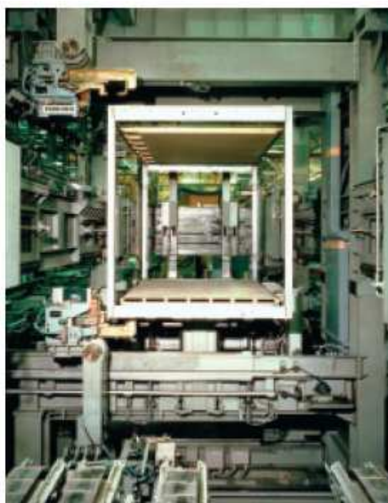
Рис. 116: Промышленная линия производства объемных строительных элементов из стали (компания "Sekisui House, Ltd.", Япония) в сопоставлении с линией в автомобилестроении ("Daimler-Chrysler")
